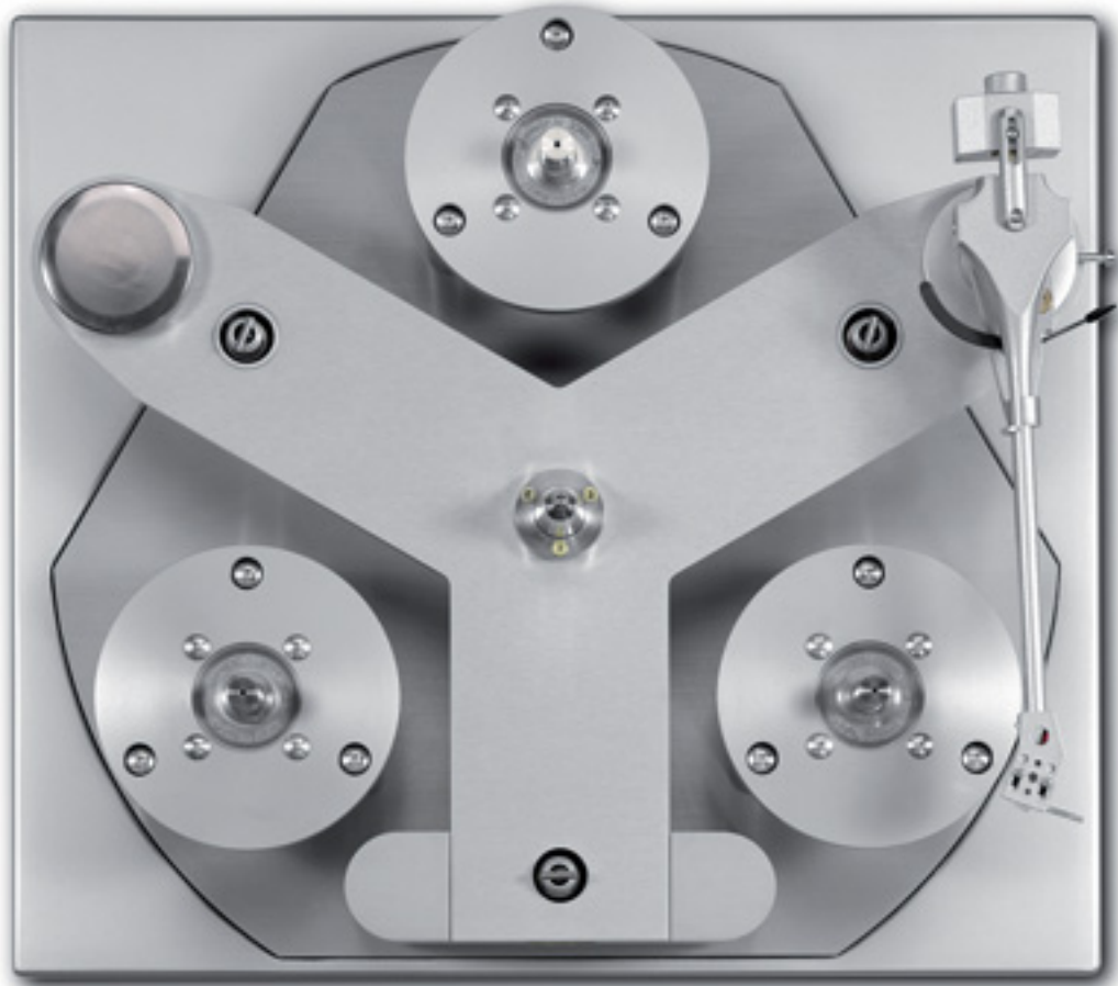
Sternzeichen: Die Papst-Motoren sind in Gummi gelagert und auf der Laufwerksbasis verankert. Drei von oben einstellbare Federelemente tragen das Y-förmige Subchassis, das für ein oder zwei 10"-Tonarme ausgelegt ist
